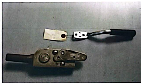
椅子用レバー式ギア 6段 実用新案No.2135470 意匠No.870202
